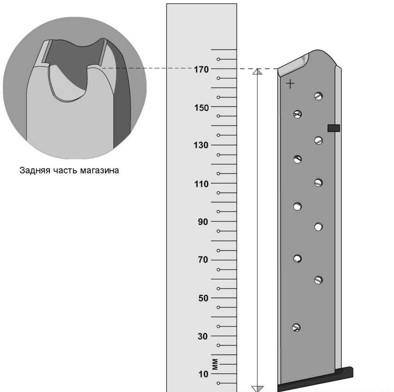
Магазин расположен в вертикальном положении на плоской поверхности, замер производится от плоской поверхности вверх, до задней части губок магазина, как показано на рисунке. Разрешены только прямые, жесткие магазины (например, гибкие, барабанные, "J", "L", "T"-образные, или магазины аналогичной формы, запрещены).
